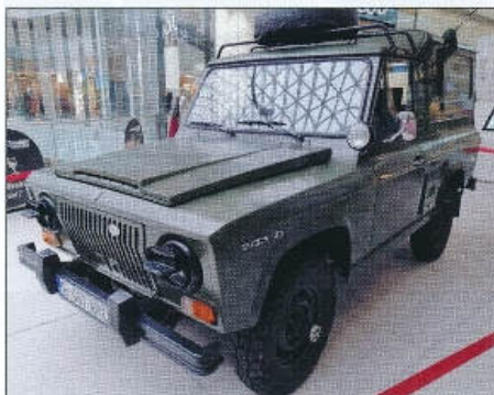
Terénní Aro 243 D s naftovým motorem 3,1 l v úpravě pro armádu a milici
