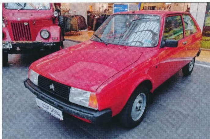
Přední kola vozu Olteit Special pohání vzduchem chlazený dvouválec 652 cm 3
