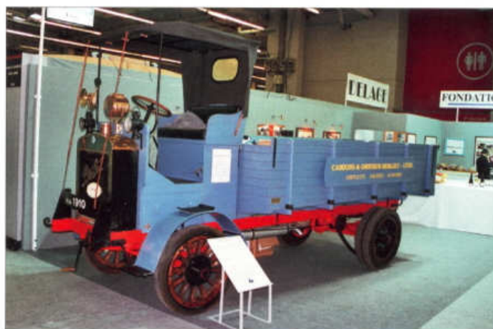
Berliet typ M o nosnosti 3,5 t poháněný čtyřválcem 4,5 l (1910)
