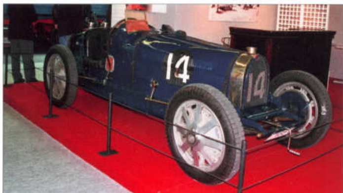
Závodní Bugatti 51 s osmiválcem 2,3 l s kompresorem (1931)
