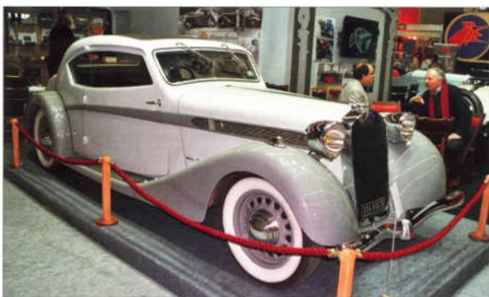
Čtyřmístné kupé Delage D 6-70 z roku 1935 s karosérií Letourneur et Marchand, která se obešla bez středních sloupků
