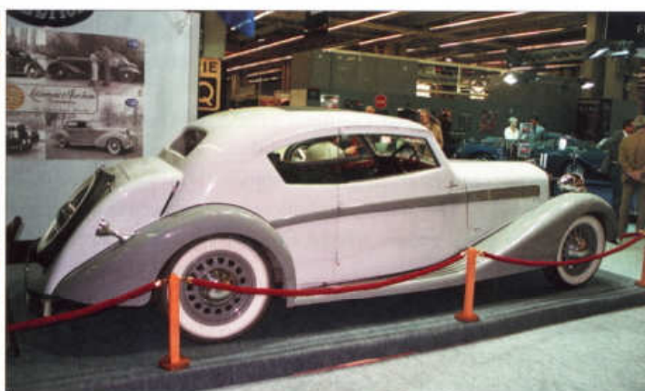
Čtyřmístné kupé Delage D 6-70 z roku 1935 s karosérií Letourneur et Marchand, která se obešla bez středních sloupků
