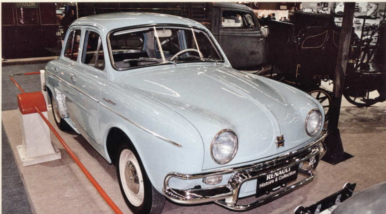
ELEKTROMOBIL HENNEY KILOWATT (1960) PŘESTAVĚNÝ V USA Z RENAULTU DAUPHINE
