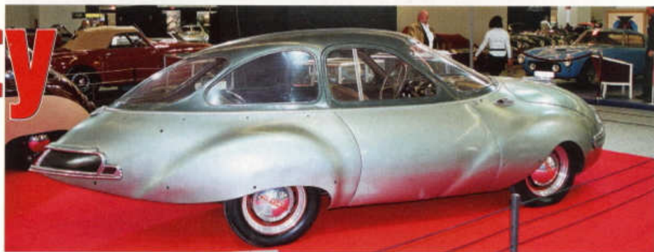
Louis Bionier dal vozu Dynavia výrazně aerodynamický tvar blížící se kapce vody
