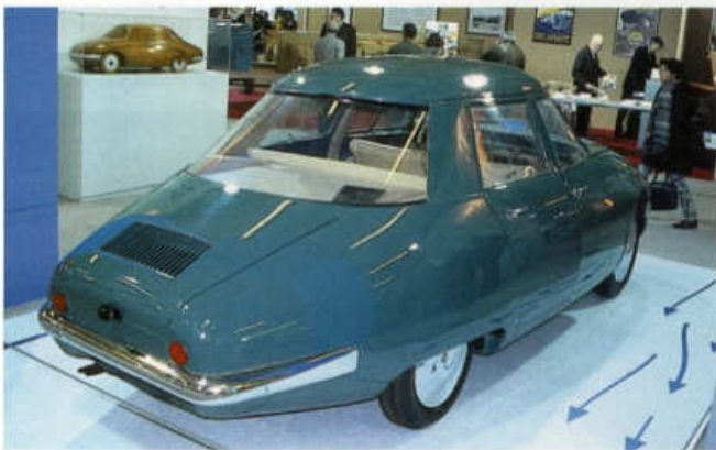
V protáhlé zádi skrýval Renault CX 15 motor z Dauphine.
