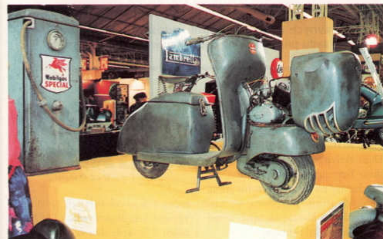
Skútr s předním pohonem - francouzský prototyp Delaplace z počátku 50. let
