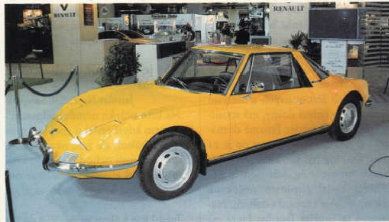
Matra 530 LX ročníku 1970 s motorem Ford V4 podélně před zadní nápravou
