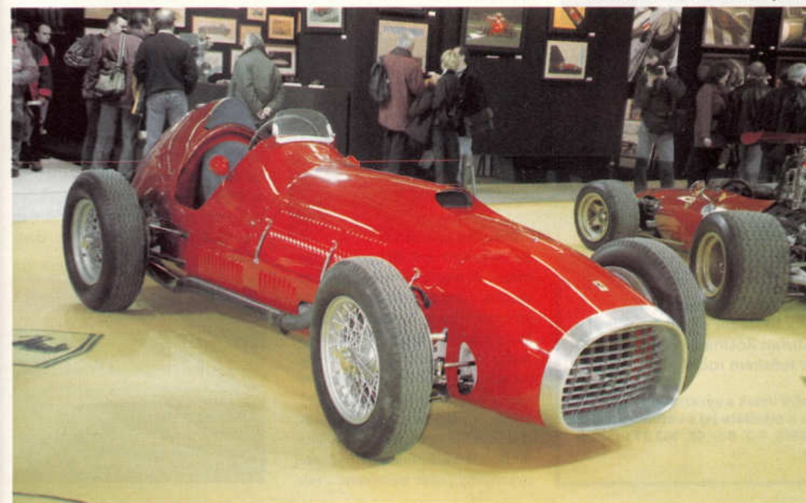
Klasický monopost Ferrari 375 F1 z roku 1951 s dvanáctiválcem 4,5 l v přídí
