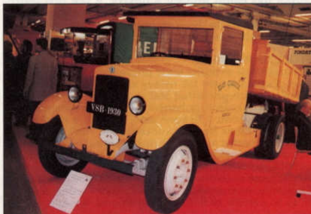
Stánku Fondation Berliet vévodila třítunová sklápěčka Berliet VSB z roku 1930 se čtyřválcovým motorem s objemem 3,3 litru.
