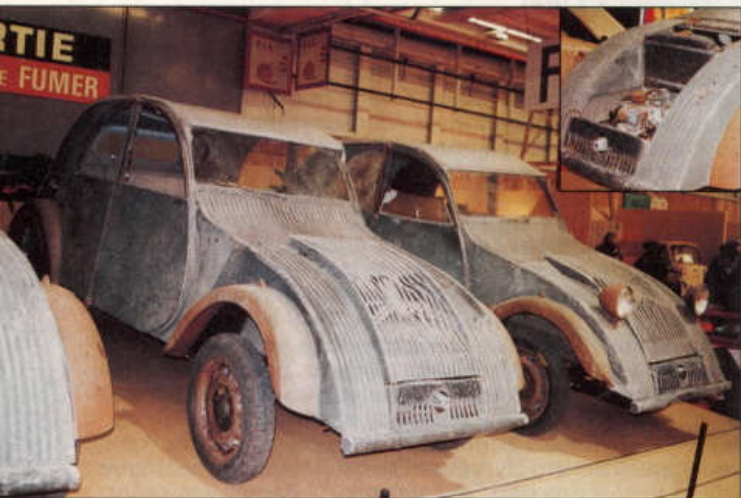
Trojice znovuobjevených předválečných vozů Citroën 2 CV, ještě s hliníkovou karosérií a motorem – ovšemže plochým dvouválcem – chlazeným vodou.
