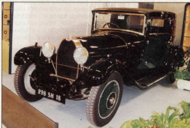
Bugatti 44 ročníku 1927 s třilitrovým osmiválcem a karosérií záměrně připomínající fiakr dokázala uhánět rychlostí až 150 km/h.
