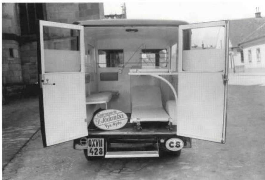
Interiér sanitky Škoda 645 se dvěma nad sebou umístěnými lehátky
