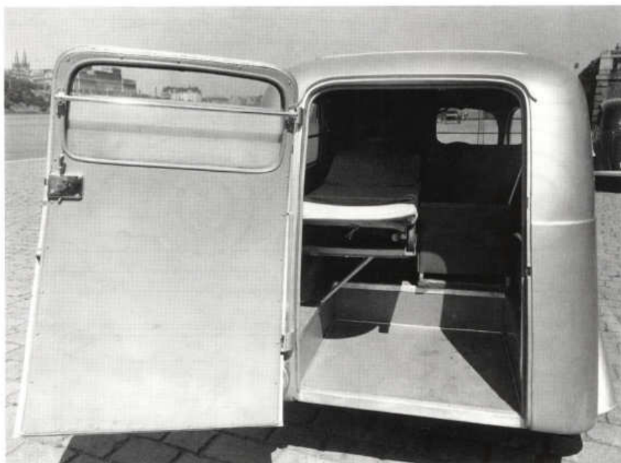
V zadní stěně měl sanitní Popular 995 po straně zavěšené dveře
