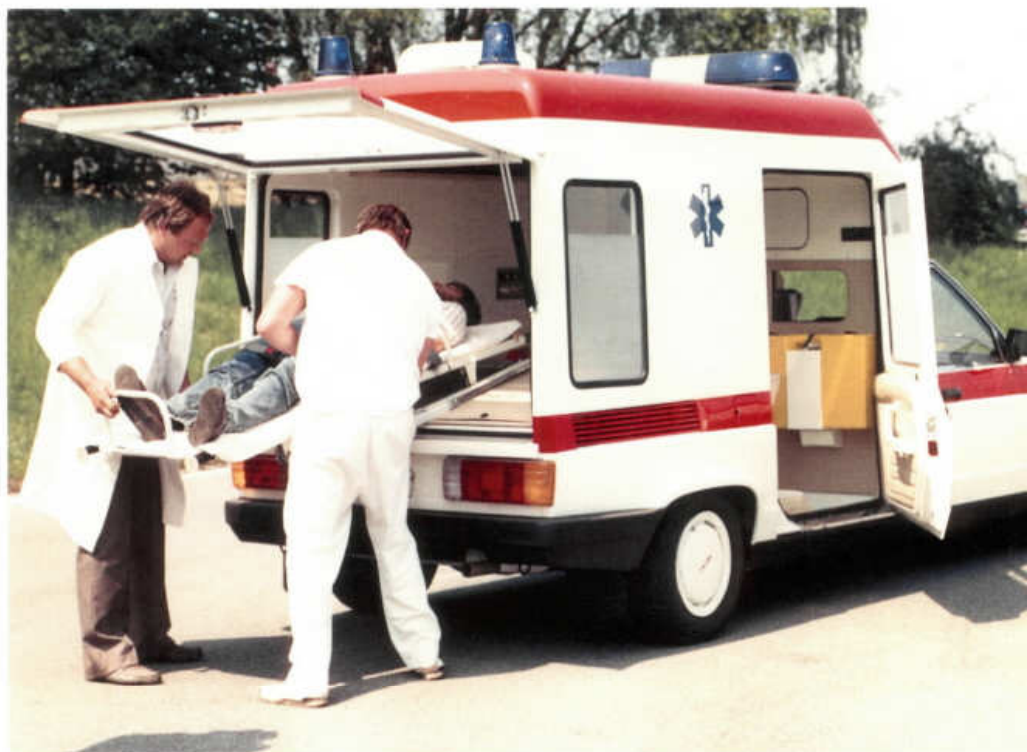
Manipulaci s nosítky ztěžoval vzadu uložený motor
