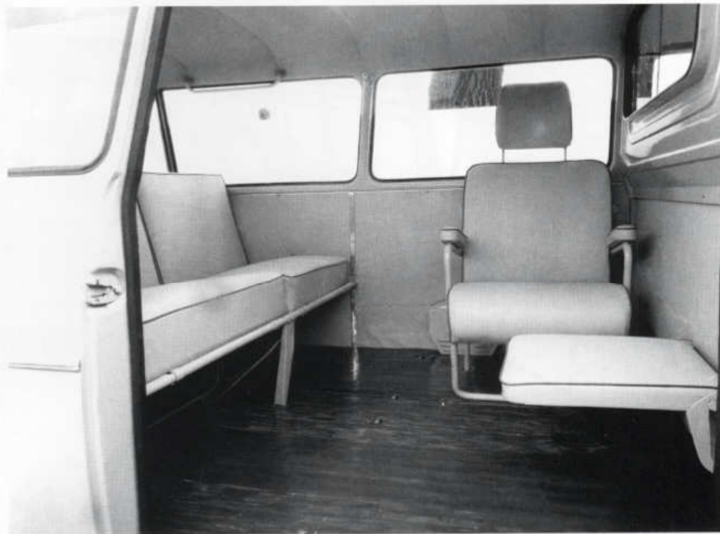
Sanitní prostor prvního prototypu v úpravě pro pět sedících osob
