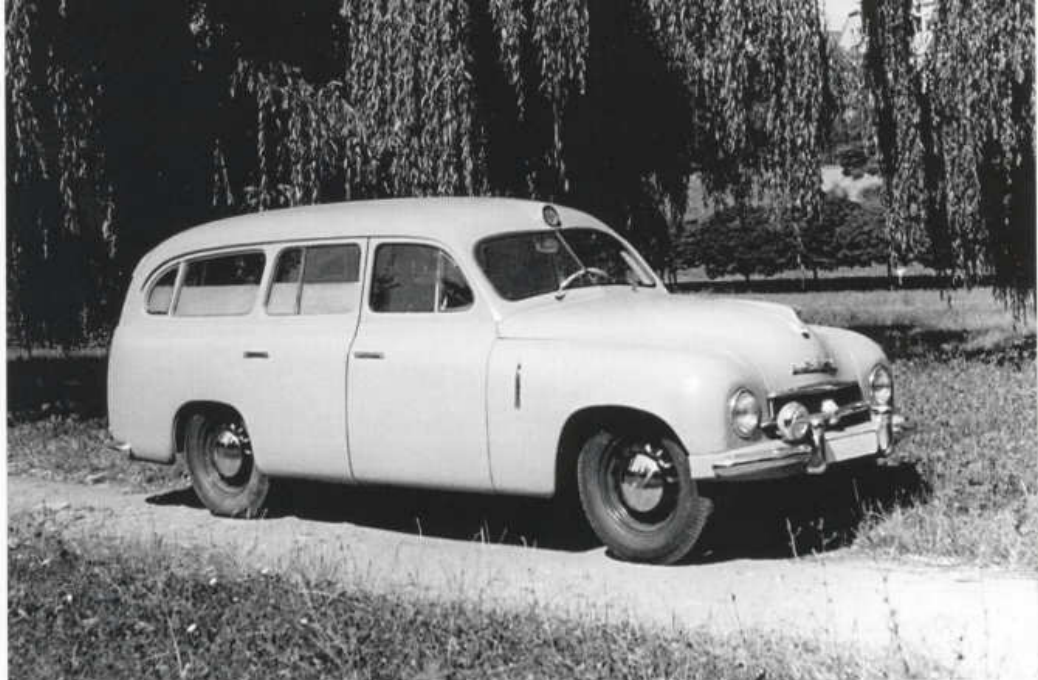
Sanitní Škoda 1200 s mechanickými směrovkami v předních blatnících
