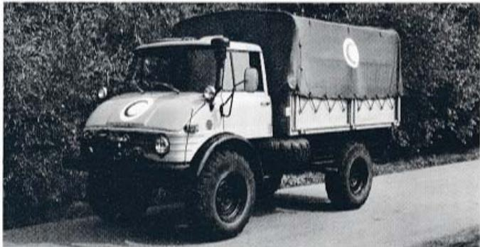
**21-25** Das Fahrzeug wird durch die variable Einrichtung, die vom Standardaufbau mit 4 Tragen und 4 Sitzen über die Planenausführung mit leicht montierbaren Krankenträger-Lageungsgestellen bis zum geländegängigen Notarztwagen (Feld-OP) reicht, allen Anforderungen, die an ein solches Fahrzeug gestellt werden, gerecht.
