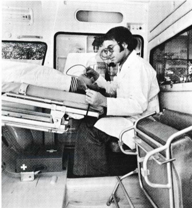
**4** Einrichtung zur Kopftieflagerung nach Trendelenburg. Kann mechanisch über Fußpedal, auch während der Fahrt, durch den Betreuer am Kopfende bedient werden.
