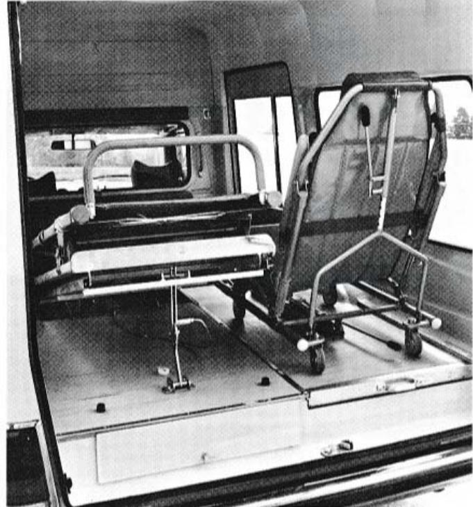
**4** Dispositif d'inclinaison progressive de la tête vers l'arrière selon Trendelenburg. Peut être actionné mécaniquement par l'infirmier même en cours de route, à l'aide d'une pédale située sous la tête.
