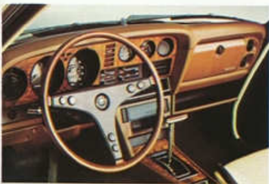
Le levier de commande de la transmission automatique est à bonne portée de la main sur une console garnie de bois polymérisé assorti au volant et au tableau de bord.
