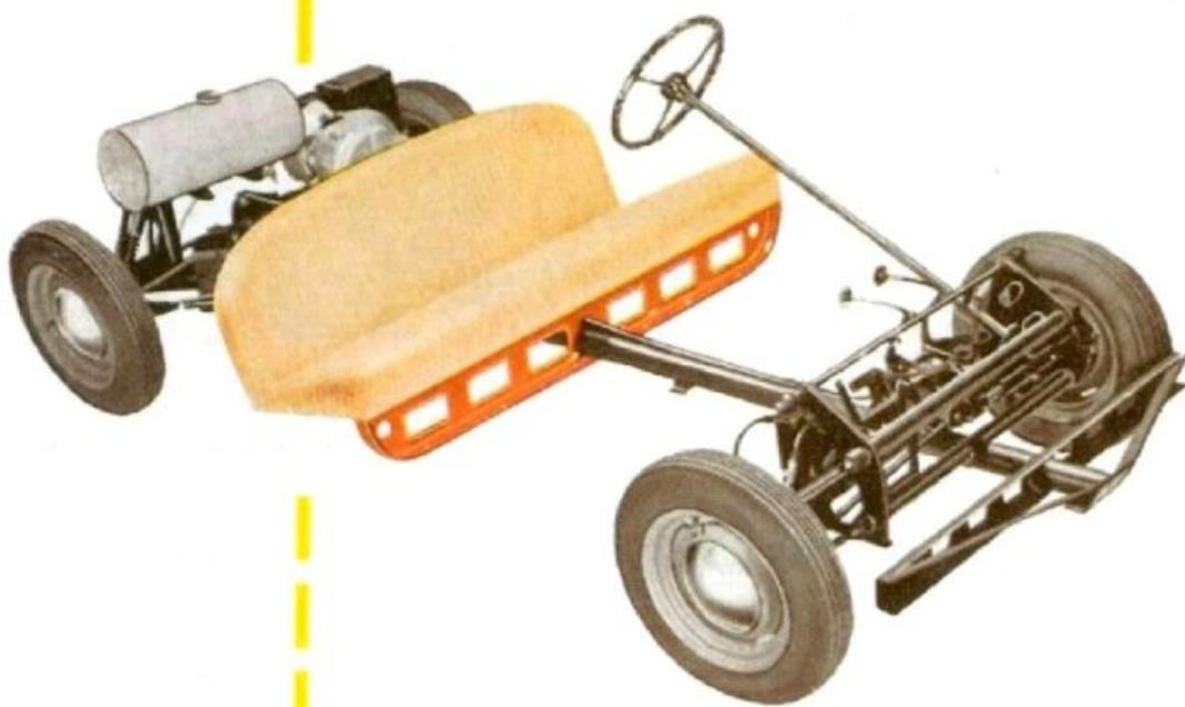
Genau in der Mitte des Hauptholmes lagert die Sitzbank; zu den Achsen wie eine Sänfte zu ihren Trägern angeordnet. Dazu die außergewöhnliche Abfederung durch Pendelachsen mit einzeln abgefederten Rädern und den hydraulischen Federbeinen: das garantiert eine angenehme Fahrt! Große Vierrad-Öldruckbremsen gewährleisten sicheres und müheloses Bremsen.
