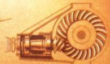
Hypoid aandrijving welke tegen alle beproevingen bestand is. Overbrenging 9 X 43.
