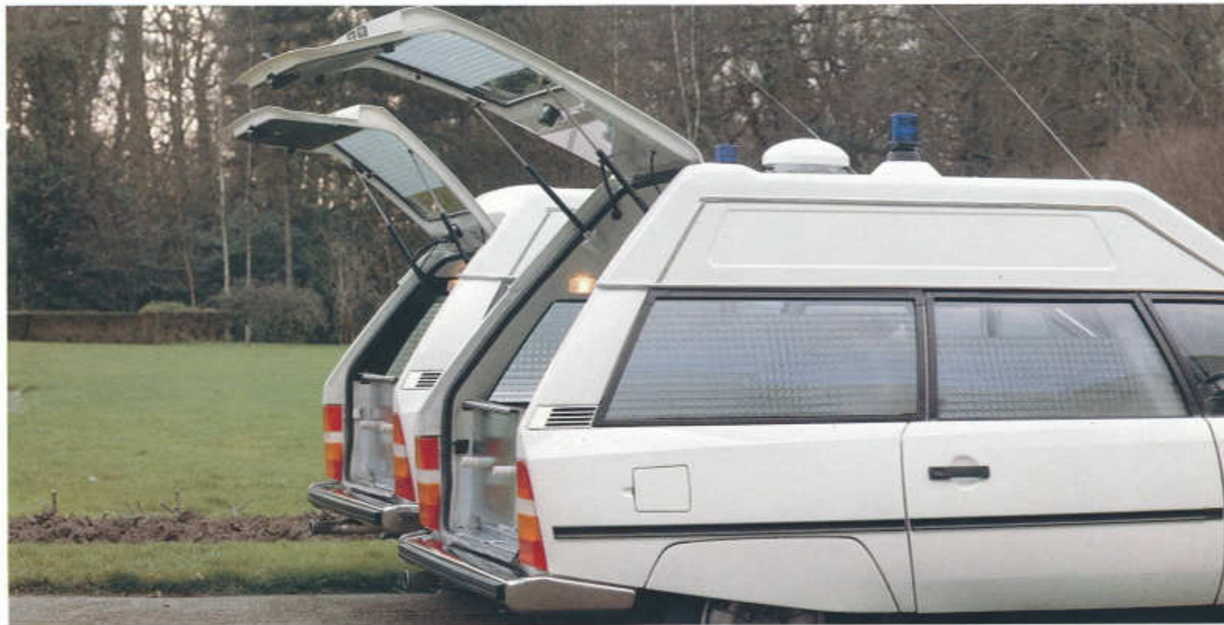
CSN 2 : Hayon arrière surélevé dégageant l'ouverture jusqu'au pavillon et facilitant l'embarquement de malades semi-couchés. Hauteur d'entrée 1140 mm
