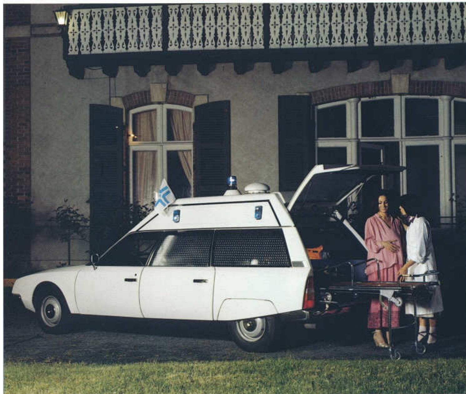
CSN 1 : Hayon arrière de break de série CITROËN conservé. Hauteur d'entrée 915 mm.
