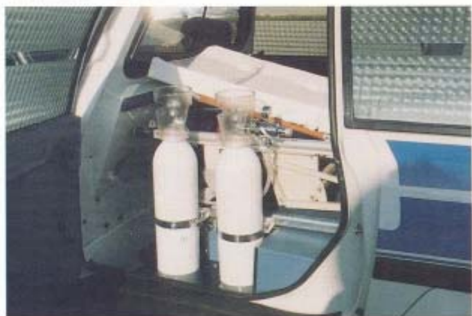
Bouteilles oxygène 1 200 litres encastrées et fixées par colliers
