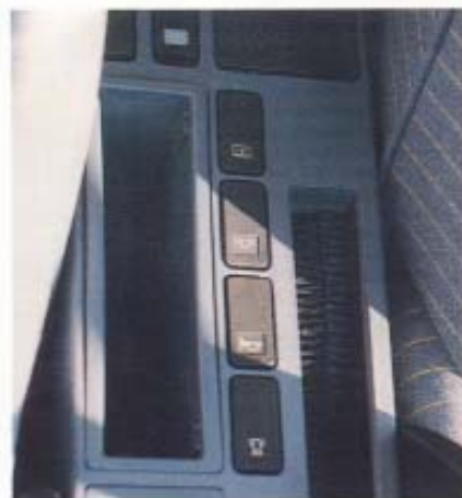
Commandes feu à éclat, la do la, circulation eau chaude, centralisées au poste de conduite, équipées d'un voyant "marche" et d'un éclairage de nuit intégrés
