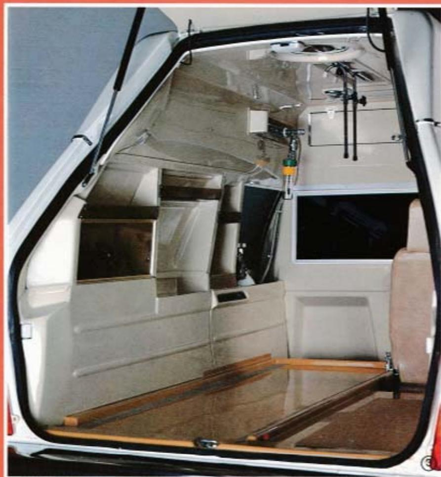
**EN OPTION**, l'ambulance G.V.N. peut être équipée d'un ensemble de modules thermoformés références MLRG qui constitue une véritable panoplie pour le rangement fonctionnel des ustensiles de bord, utilisés dans ce genre de véhicule.
