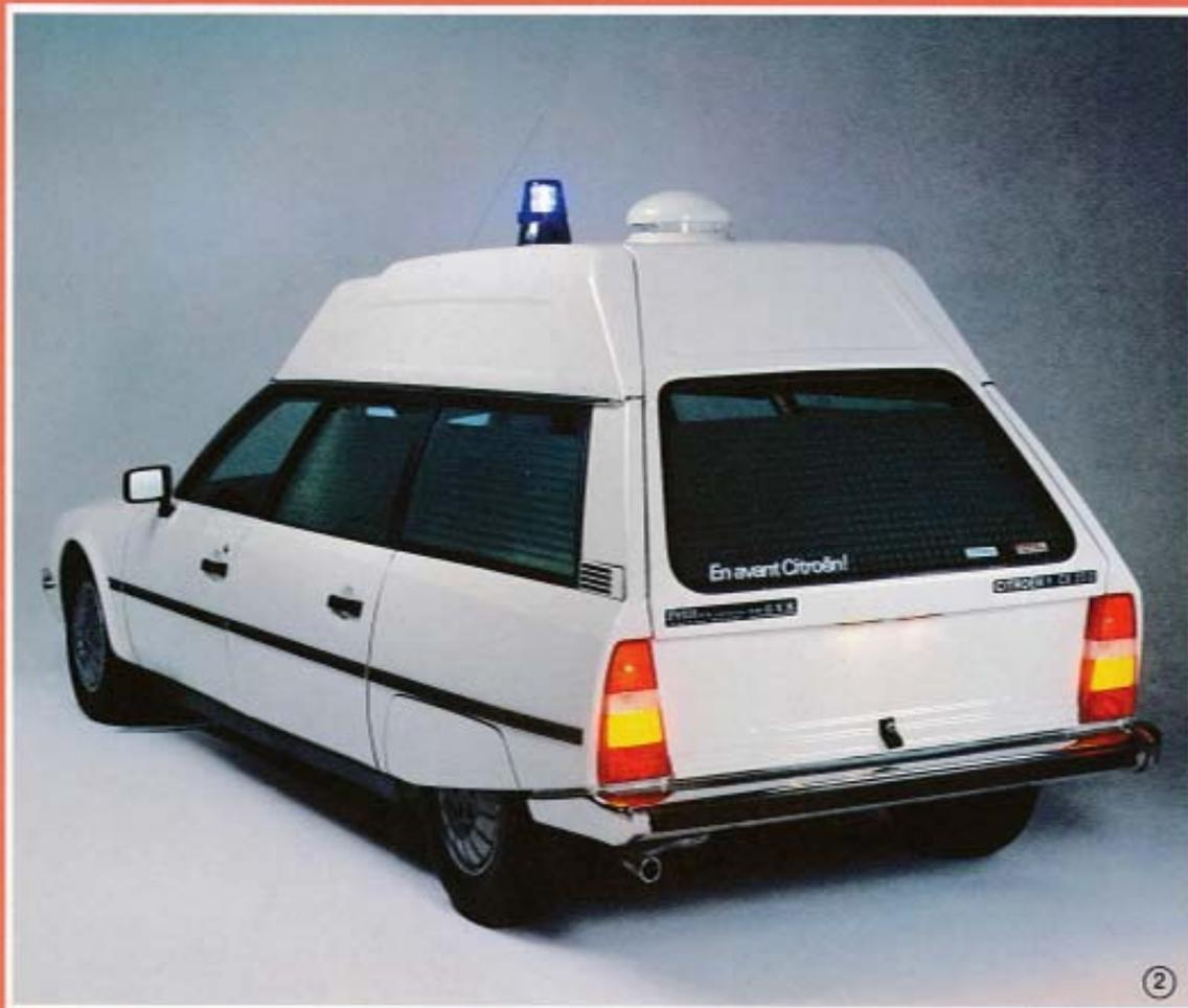
Le hayon arrière, monobloc, en stratifié est également pourvu d'une double paroi, prenant en « sandwich » une structure tubulaire.
