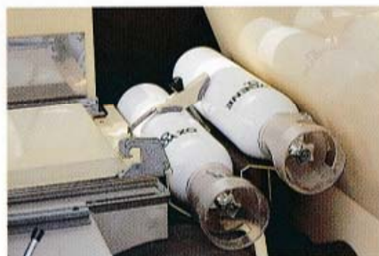
Logement des bouteilles à oxygène à l'horizontale. Accès facile aux manomètres et détendeurs.
