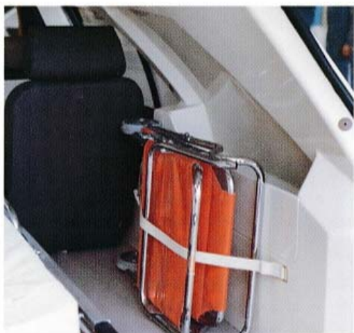
Siège accompagnateur fixe avec repose-tête. Sangle de fixation pour chaise portoir sur panneau latéral droit.
