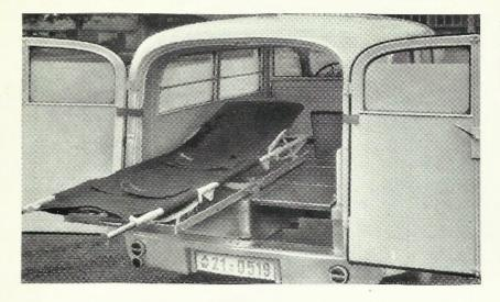
Die Schiebebühne mit eingebauten Kugellagerrollen und Feststellhebel ist etwa 650 mm ausziehbar. Auf den heruntergeklappten Rückenlehnen der seitlichen Sitze kann bei Bedarf ein zweiter liegender Patient befördert werden.
