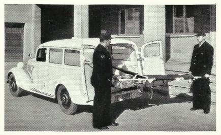
Ein weiterer zusammenklappbarer Sitz ist unter der Trage eingebaut. Bei Bedarf wird die Trage zusammengelegt und hinter die Sitzlehne zurückgeschoben.
