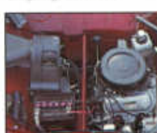
Motor und Antriebsaggregate auf der Vorderachse
