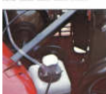
Elektrische Scheibenwaschanlage, 1,5 Liter Inhalt
