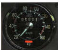
Warnlampe beim Ausfall eines Bremskreises
