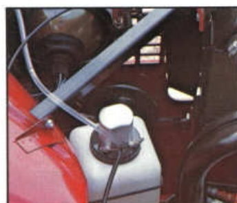
Elektrische Scheibenwaschanlage, 1,5 Liter Inhalt
