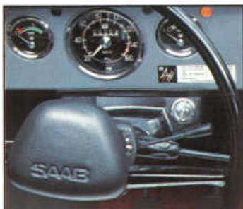
Kombi-Hebel für Hupe, Scheibenwischer und Scheibenwaschanlage
