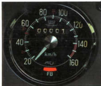
Warnlampe beim Ausfall eines Bremskreises
