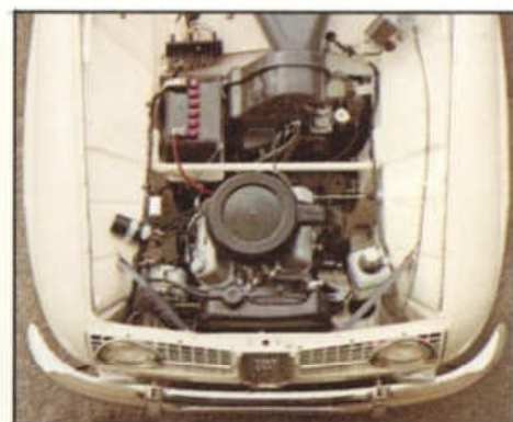
Výkonný motor V4 (73 k SAE)
