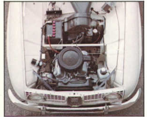
V4-Motor, 65 DIN PS (73 SAE).
