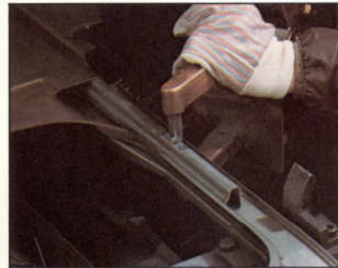
Starke Stahlprofile in den Windschutzscheiben- und Seitenpfosten.
