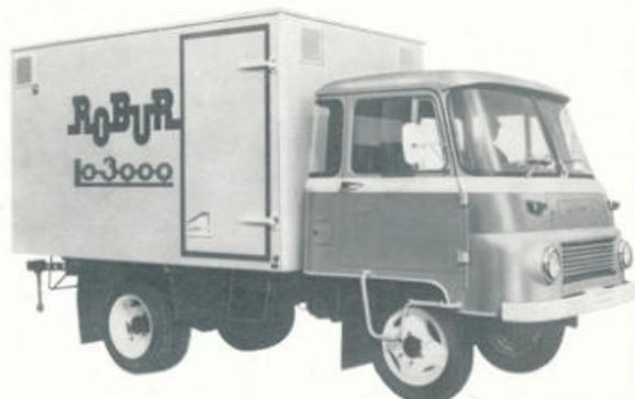
Dieses Nutzfahrzeug ist der vielseitige Transporter zur Beförderung von Industriewaren und Nahrungsgütern. Der Kofferaufbau ist in Leichtbauweise gefertigt.
