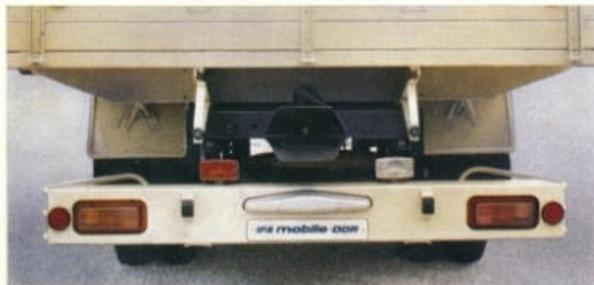
Der für unsere Nutzfahrzeuge speziell entwickelte Unterfahrschutz mit seinen seitlichen Abweisern dient bei Verkehrsunfällen der Verhinderung schwerer Schäden. Er ist deshalb konstruktiv so entwickelt, daß beim Auftreffen einer bestimmten Kraft durch das Abscheren von Bolzen ein Dämpfungseffekt erreicht wird.
