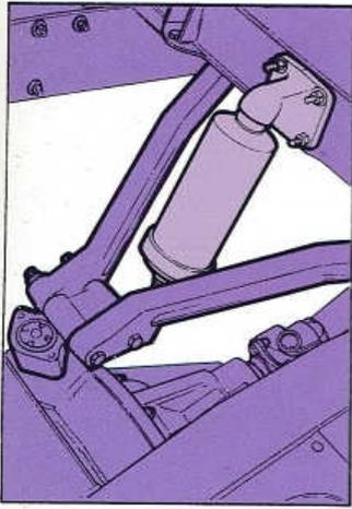
Der hintere Dreiecklenker des Range Rover ist mit einem Niveauregler ausgerüstet, der Wagenhöhe und Federungseigenschaften bei wechselnder Zuladung und beim Mitführen eines Anhängers konstant hält.
