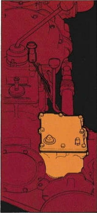
Das dritte Differential des Range Rover, zwischen der Vorder- und der Hinterachse liegend, verhindert zuverlässig ein Verdrehen der Antriebswellen und löst souverän die Probleme, die der permanente Allradantrieb vor allem bei hohen Geschwindigkeiten aufwirft. Im schweren Geländeeinsatz gewährleistet die Differentialsperre eine möglichst optimale Kraftübertragung.
