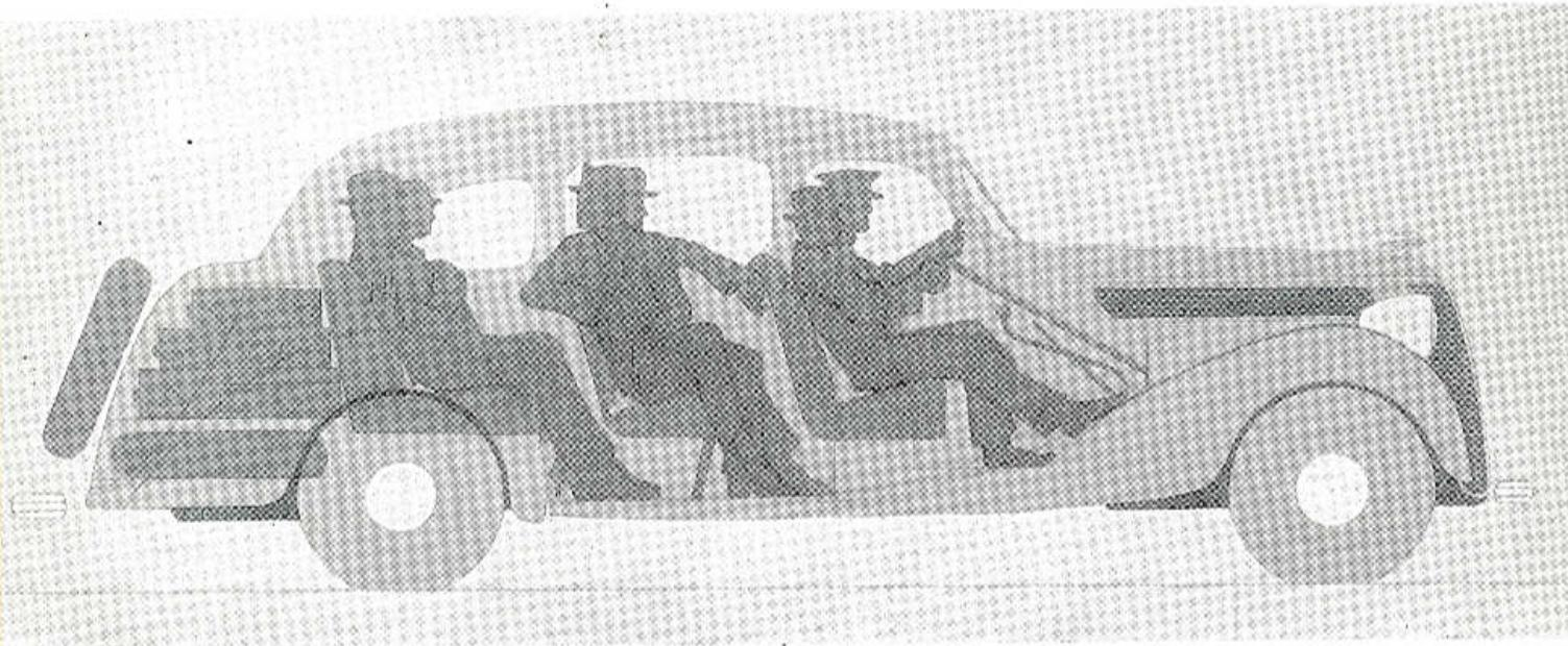
Velký prostor na zavazadla je přístupný z vnitřku i z vnějšku. Šípové okno před řidičem i všechna ostatní okna jsou opatřena bezpečnostním netřístitelným sklem. Není ani třeba zdůrazňovat, že karoserie vozu Praga Alfa uložená na gumě a opatřená hmotami pro tlumení hluku i vibrací u všech kovových stěn, je úplně tichá. Tichost je známá přednost všech nových vozů Praga.
