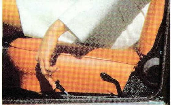
Zwei Hebel jeweils an der Aussenseite der Vordersitze ermöglichen deren Verstellung sowie die Regulierung der Rückenlehnen.
