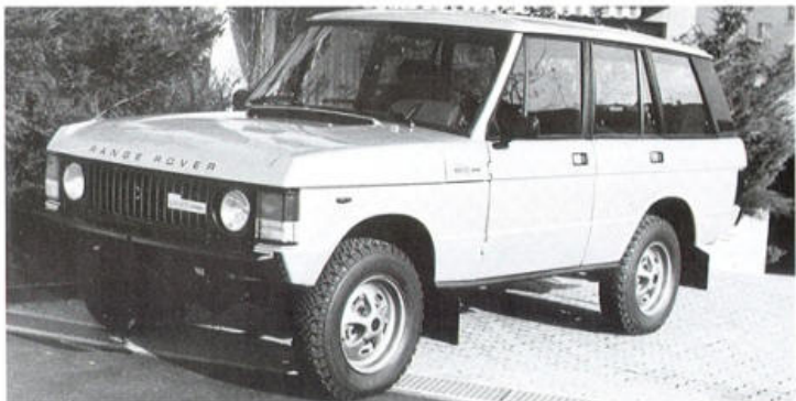
Range Rover/MONTEVERDI-Design mit 5 Türen auf Original-Radstand. Diese Version wurde von British Leyland unter verschiedenen Prototypen ausgewählt und in Serienmontage hergestellt
