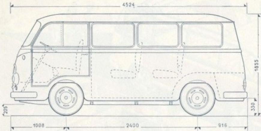
Sasija je izdelana iz profilnega jekla; karoserija jeklena, elektrozvarjena, zavore hidravlične; ročna zavora mehanična, deluje na zadnja kolesa; vzmetenje spredaj listnata, zadaj torzijska vzmet; teleskop amortizerji; teža vozila 1200 kg; dovoljena obremenitev 1000 kg.
