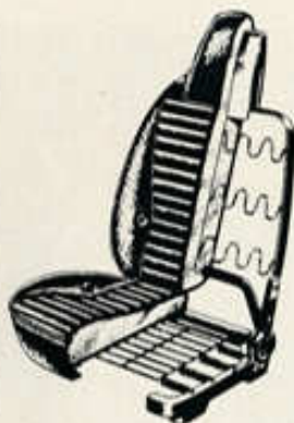
Neues Federungsmaterial und gute anatomische Form sorgen für ermüdungsfreies Fahren und sichern seitlichen Halt.
