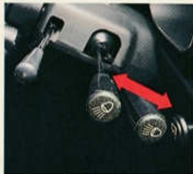
Direkt am Lenkrad, in Fingerspitzen-nähe, sind die Bedienungshebel für Licht, Lichthupe und Blinker angebracht.
