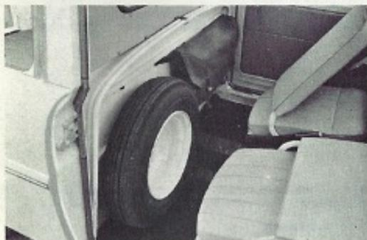
Hinter dem Beifahrersitz ist das Ersatzrad an der Führerkabine-Rückwand untergebracht. Ebenfalls an der Rückwand können ohne weitere Vorkehrungen die Plane und die Spriegel aufbewahrt werden. Hinter dem Fahrersitz ist genügend Raum für kleine Pakete und Frachtpapiere.
