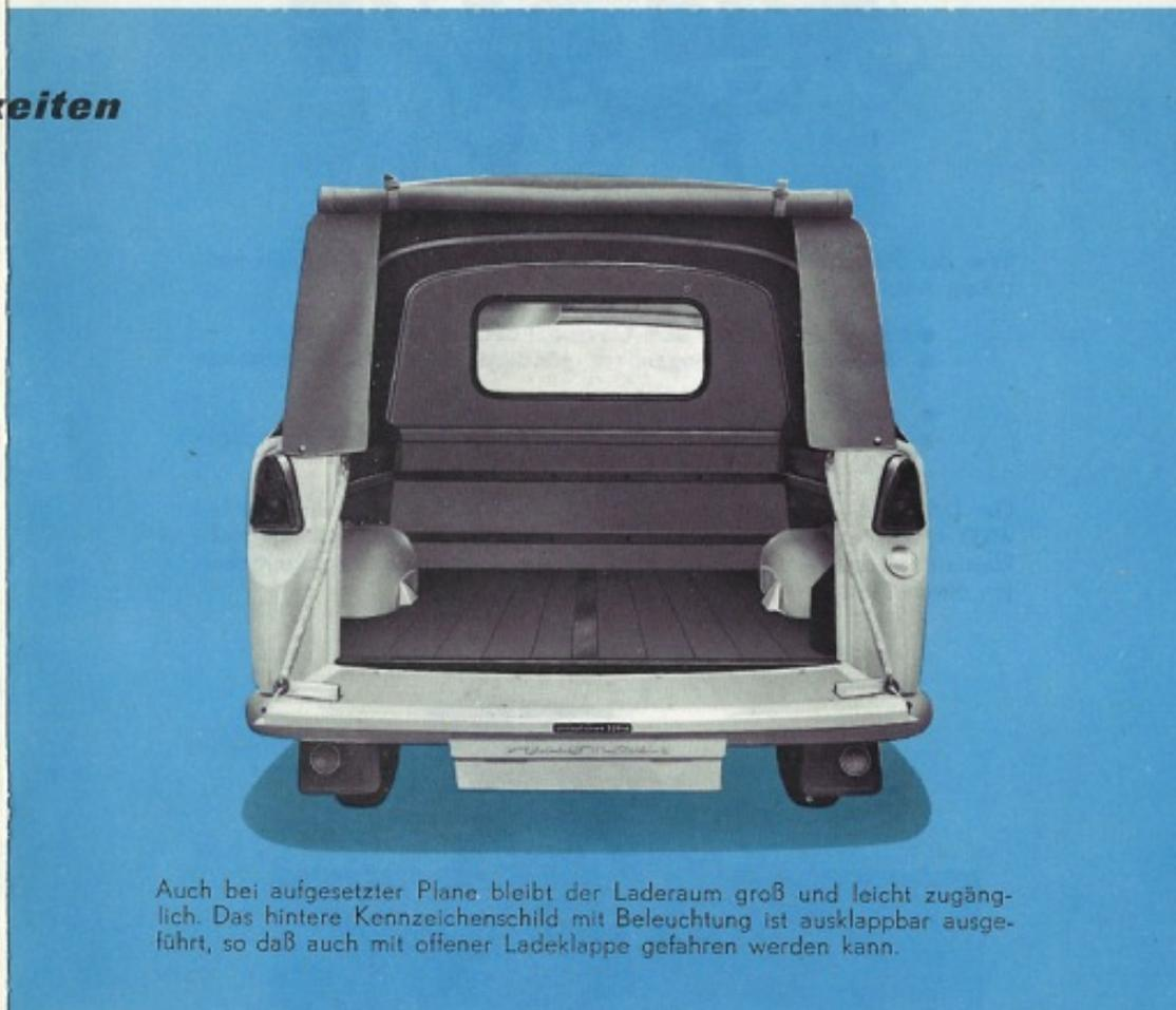
Auch bei aufgesetzter Plane bleibt der Laderaum groß und leicht zugänglich. Das hintere Kennzeichenschild mit Beleuchtung ist ausklappbar ausgeführt, so daß auch mit offener Ladeklappe gefahren werden kann.
