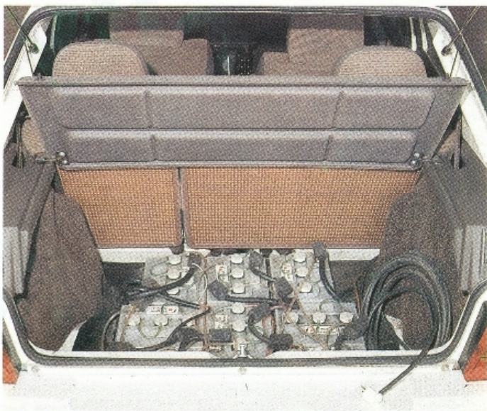
Uložení akumulátorů v zadní části elektromobilu
