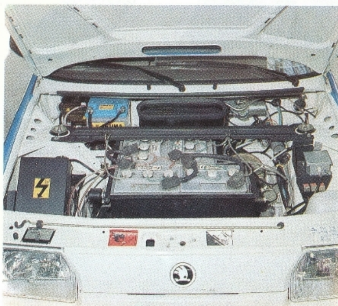
Uložení akumulátorů v přední části elektromobilu
