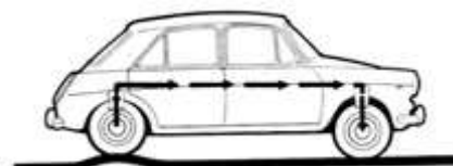
Prednji deo se podiže u skladu sa kretanjem zadnjih točkova naviše — bez klačenja!
