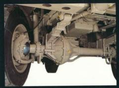
Direction: position à gauche, c'est un mécanisme à vis globique et galet tournant. 6 tours de volants sont nécessaires pour un braquage extrême de gauche à droite et le diamètre de braquage du véhicule, toutes saillies comprises, est de 17 mètres.
