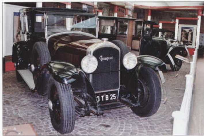
Peugeot 174 (1923) se čtyřválcem 3,8 l a brzdami na všech kolech
