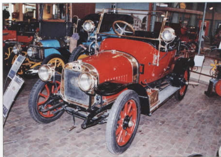
Lion Peugeot V4C3 (1912) s motorem V4 o objemu 1,7 l dosahoval až 60 km/h
