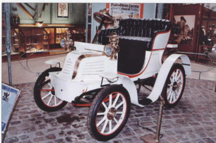
První s volantem a motorem vpředu: jednoválcový typ 36 ročníku 1901
