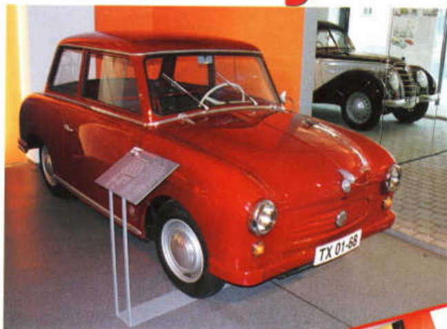
Prototyp budoucího malého vozu P50 ještě s plechovou karosérií (1954)
