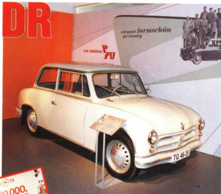
P70, první automobil s povrchovými panely karoserie z Duroplastu (1955–1959)
