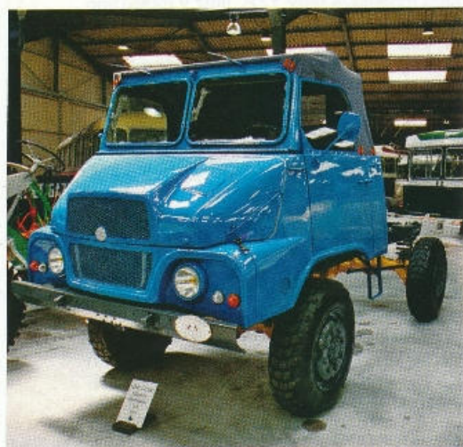
Terénní vůz Simca-Unix 1,5 t s motorem Ford V8 (1971)
