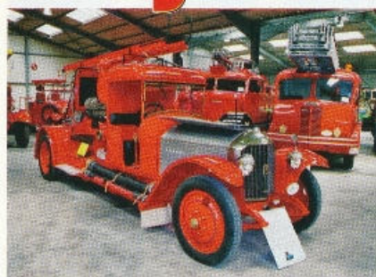
Hasičský Rochet-Schneider typ 18400 se šestiválcem 6,2 l (1921)
