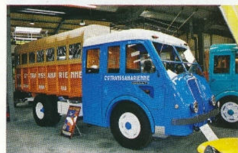
Saharský speciál Renault AGKD se vznětovým čtyřválcem 8,4 l (1937)
