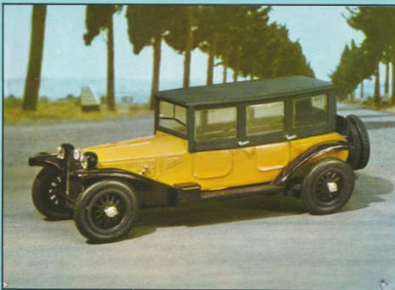
② LANCIA LAMBDA - CON HARDTOP cmc 2120 mm 75 x 120 HP 49 velocità kmh 115/120
