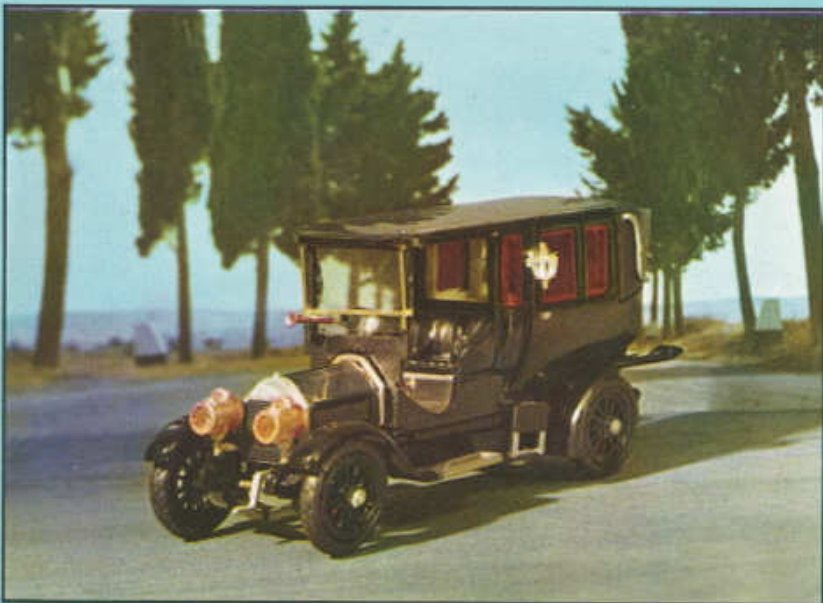
⑥ ITALA 1907 - PALOMBELLA Questa auto fu costruita appositamente per la Regina Margherita cmc 7433 mm 130 x 140 HP 45
