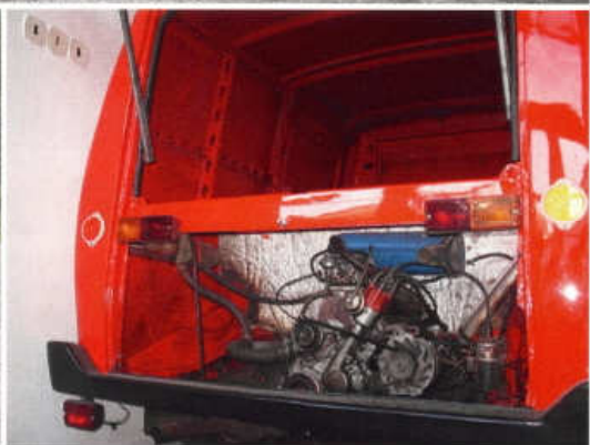
Motor za zadní nápravou komplikoval využití vnitřního prostoru
