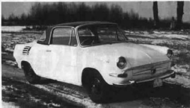
Prototyp dvoudveřového vozu Š 990 Tudor bez středních sloupků.
