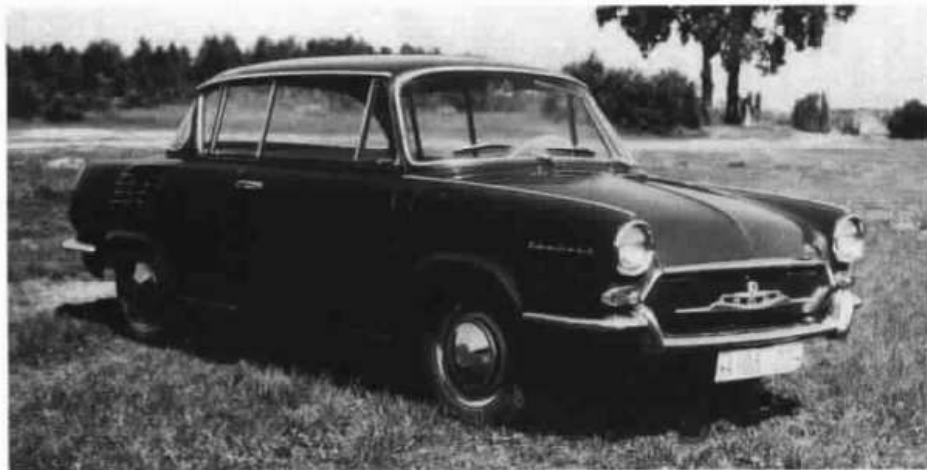
Prototyp dvoudveřového vozu Š 990 Tudor bez středních sloupků.
