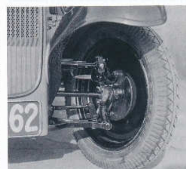
Přední kolo Z 4 s hnacím hřídelem opatřeným křížovým kloubem
