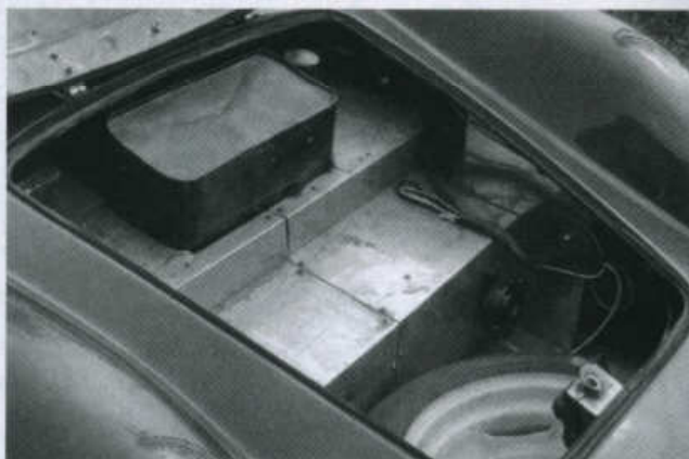
Pod přední kapotu se vešlo náhradní kolo, akumulátor a palivová nádrž
