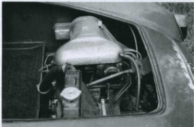
Před motorem byla umístěna plošina na přepravu zavazadel (vlevo)
