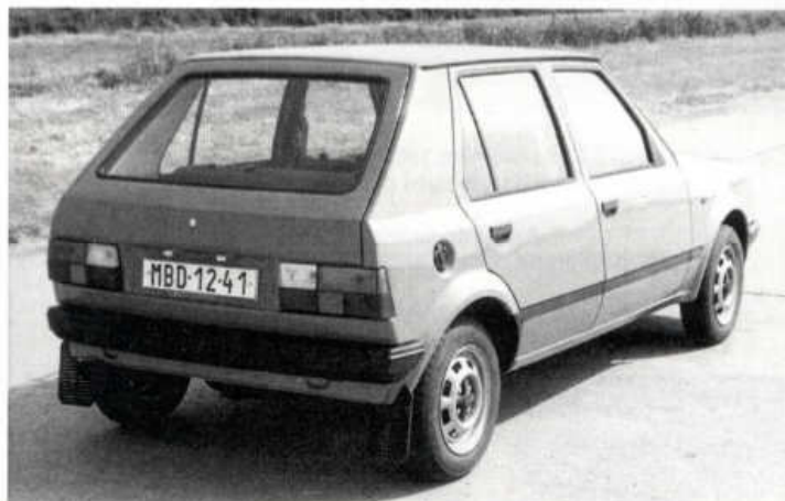
▲ Čtveřice bočních dveří a výklopné víko v zádí se u Š 781 staly samozřejmostí
