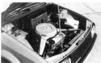
Od jara 1984 měly opakované prototypy nový čtyřválec OHV 1,3l
