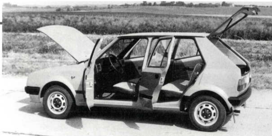
▲ Čtveřice bočních dveří a výklopné víko v zádí se u Š 781 staly samozřejmostí
