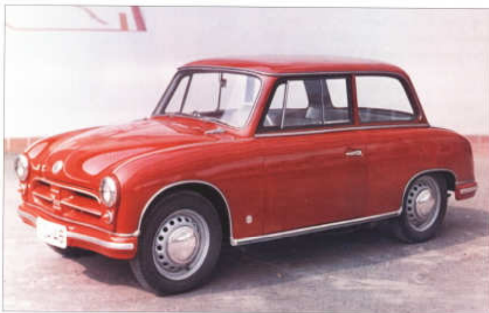
Mezityp P 70 měl dřevěnou kostru karoserie pokrytou panely z Duroplastu
