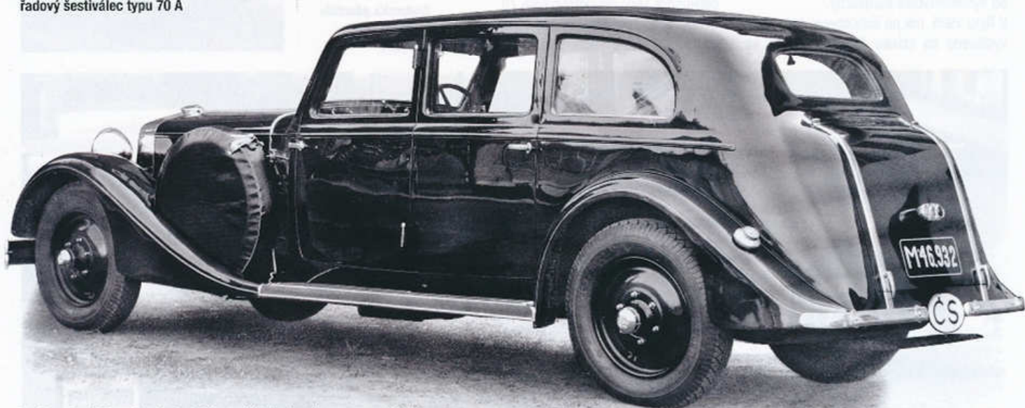
Zaoblená záď limuzíny Tatra 70 A s vyklápěcím víkem zavazadelníku
