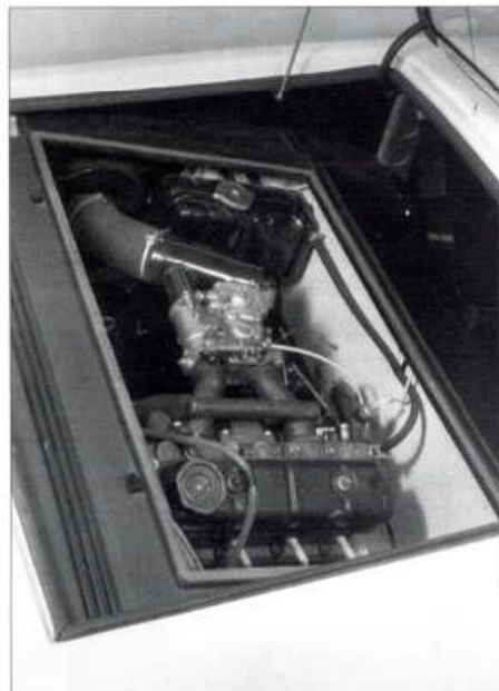
Čtyřválec 1140 ccm se skrýval v zádi pod čalouněným krytem
