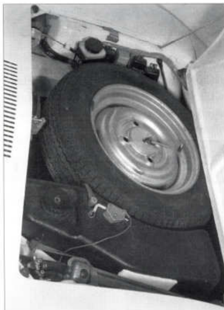
Pod přední kapotou bylo náhradní kolo obklopené palivovou nádrží
