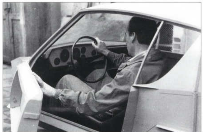
Takhle se zkušela obyvatelnost kabiny budoucího automobilu
