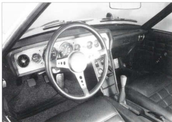
Palubní desku zdobilo šest kruhových přístrojů a elektrické hodiny
