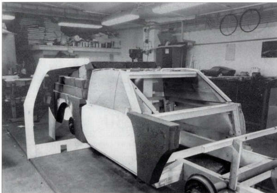
Vzácný snímek ze stavby hlavního modelu kupé v měřítku 1:1
