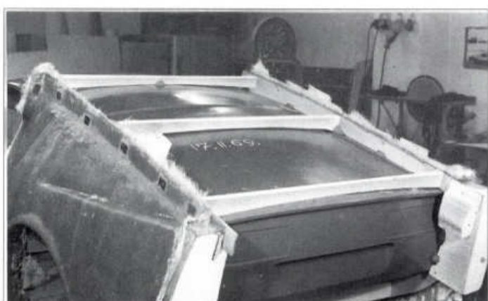
Takhle vznikala forma na výrobu zadní partie karoserie
