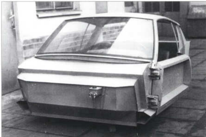
Důležitou pomůckou byla dřevěná maketa prostoru pro cestující
