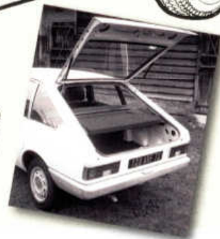
Zadní páté dveře byly opatřeny plynovými vzpěrami
